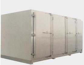
BJ-PBF液压式平板速冻机通过液压系统牵引直接与冷冻食品接 触,并有一定压紧力,具有冻结速度快、效率高、耗电省、卫生 条件好、占地范围小,可在常温下操作等优点,使用本机能最大 限度地减少食品的干耗,确保食品鲜度,设备生产执行标准是: SB/T10344-2001《食品平板式冻结装置》(国家行业标准)。
