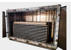
整个液压系统分为油缸、液压站两部分 组成,一只油缸位于平板冻结器中间,油缸 经研磨加工,活塞杆表面镀硬铬处理,使油 缸使用寿命长,不泄漏,液压站上电磁阀可 控制平板向上或向下运动。
